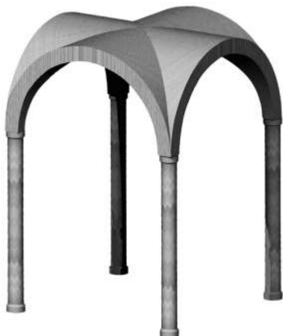
Ryc. 75. Schemat konstrukcji sklepienia krzyżowego
